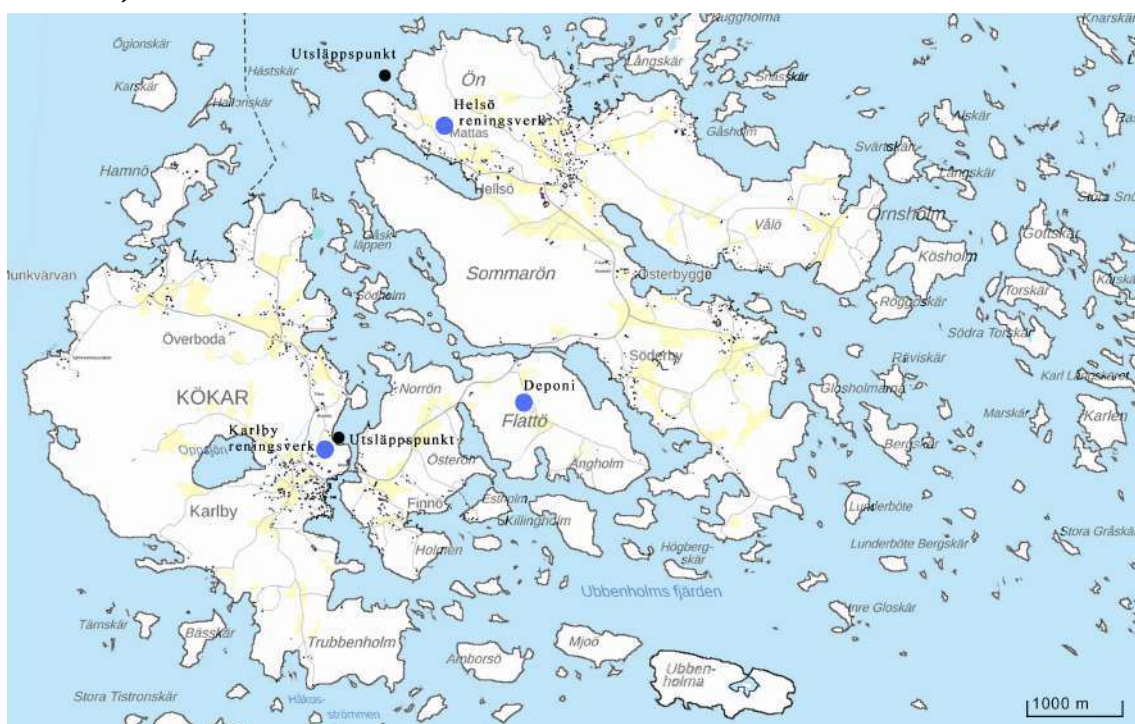
Figur 20. Placeringen av Kökars kommunala avloppsreningsverk och deras respektive utsläppspunkter. Noterat på kartan är även kommunens nu nedlagda deponi. Denna används för att lägga det slam (biomassa) som genomgått reningsprocessen.
