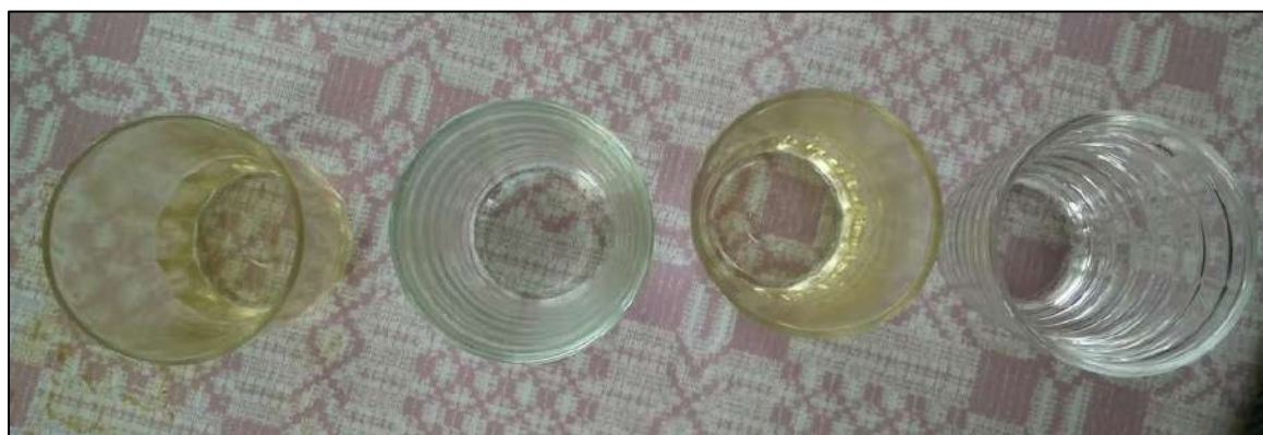
Figur 7. Dricksglas som blivit missfärgade och fått en gulaktig ton på grund av hushållsvattnets innehåll av järn och mangan.
